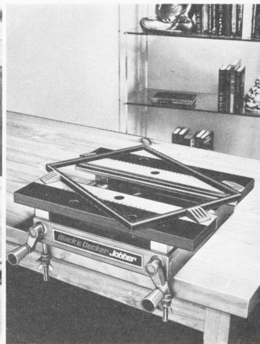
Des cales maintiennent avec précision des pièces plus importantes ou de formes rondes.
