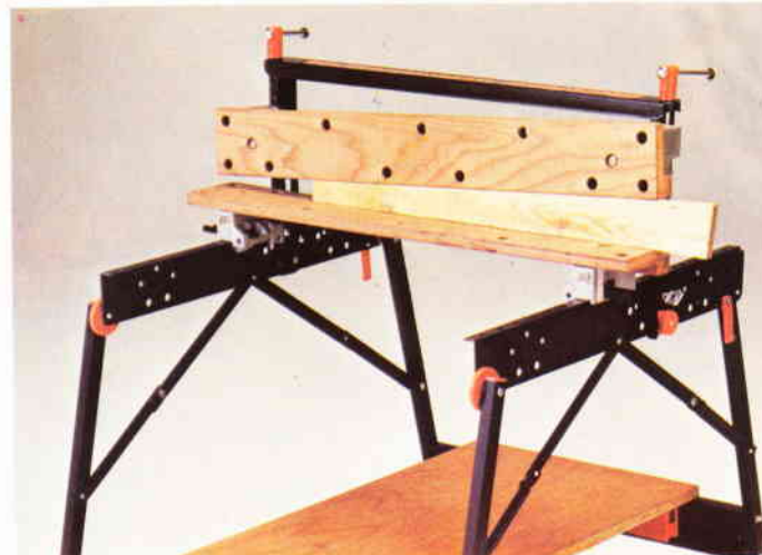
Des pièces coniques peuvent être bloquées verticalement.
