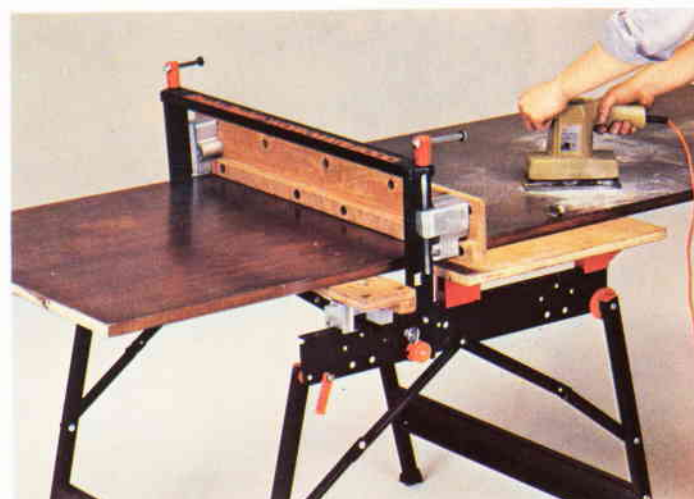
Une porte de grande dimension peut être serrée entre les 3 surfaces de travail.
