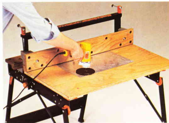
Les feuilles métalliques les plus fines sont maintenues en sécurité.
