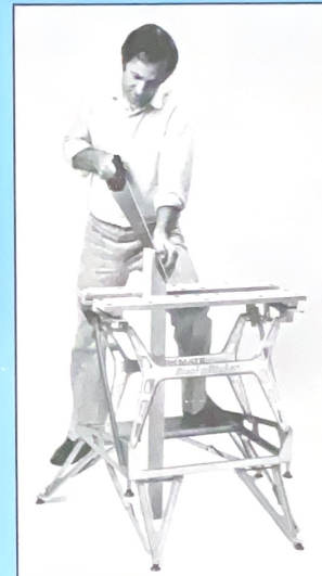
Durch das senkrechte Einspannen von Kantenhölzern werden Arbeiten wie Sägen und Hobeln an der Stirnseite erheblich vereinfacht.
