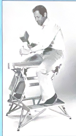
Bei Arbeiten mit dem Stechbeitel empfiehlt es sich, auf der Allzweck-Werkbank Workmate® zu sitzen. So kann das Werkstück bequem bearbeitet werden.
